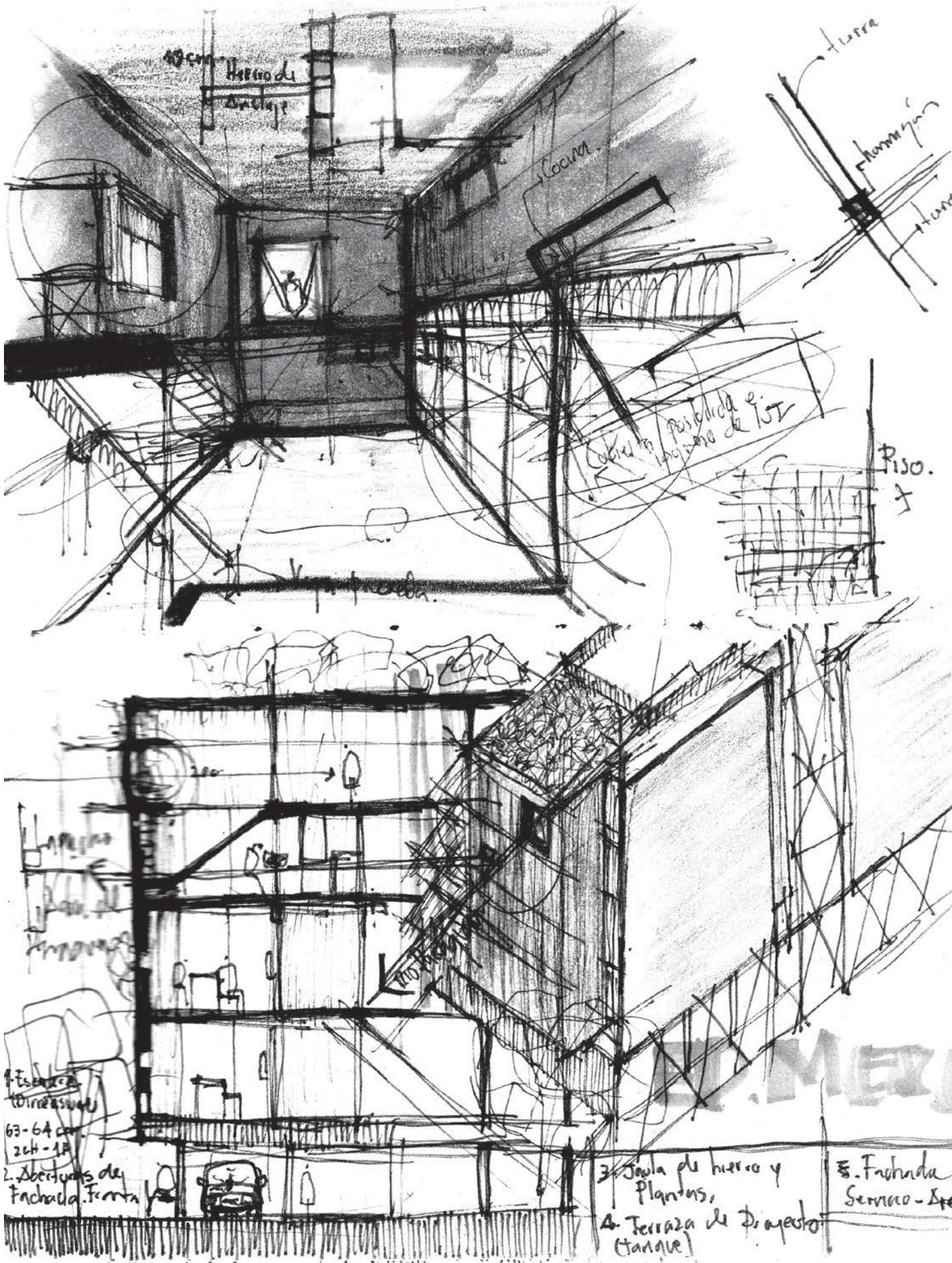
En planta, el edificio se compone de dos bloques centrales de tierra interrumpidos por las escaleras y un ascensor. Se proyecta una caja central de tierra que se perfora puntualmente. Los bloques terminan en una terraza con vistas al paisaje chaqueño y al río Paraguay.
