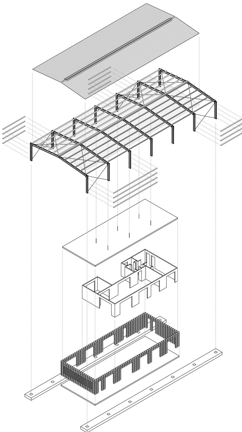
Inspirada en los secaderos de tabaco y pimientos de La Vera, la construcción está compuesta por una pastilla del mismo bloque de hormigón usado en estos y una estructura prefabricada de GPS técnicas metálicas que la protege del sol y la lluvia como si de un paraguas o un sombrero se tratase. La estructura metálica nos ofrece la sensación de interior, de cobijo psicológico, de espacio propio, mientras que dentro de la estructura de bloque se presenta el mundo confortable, acondicionado.
